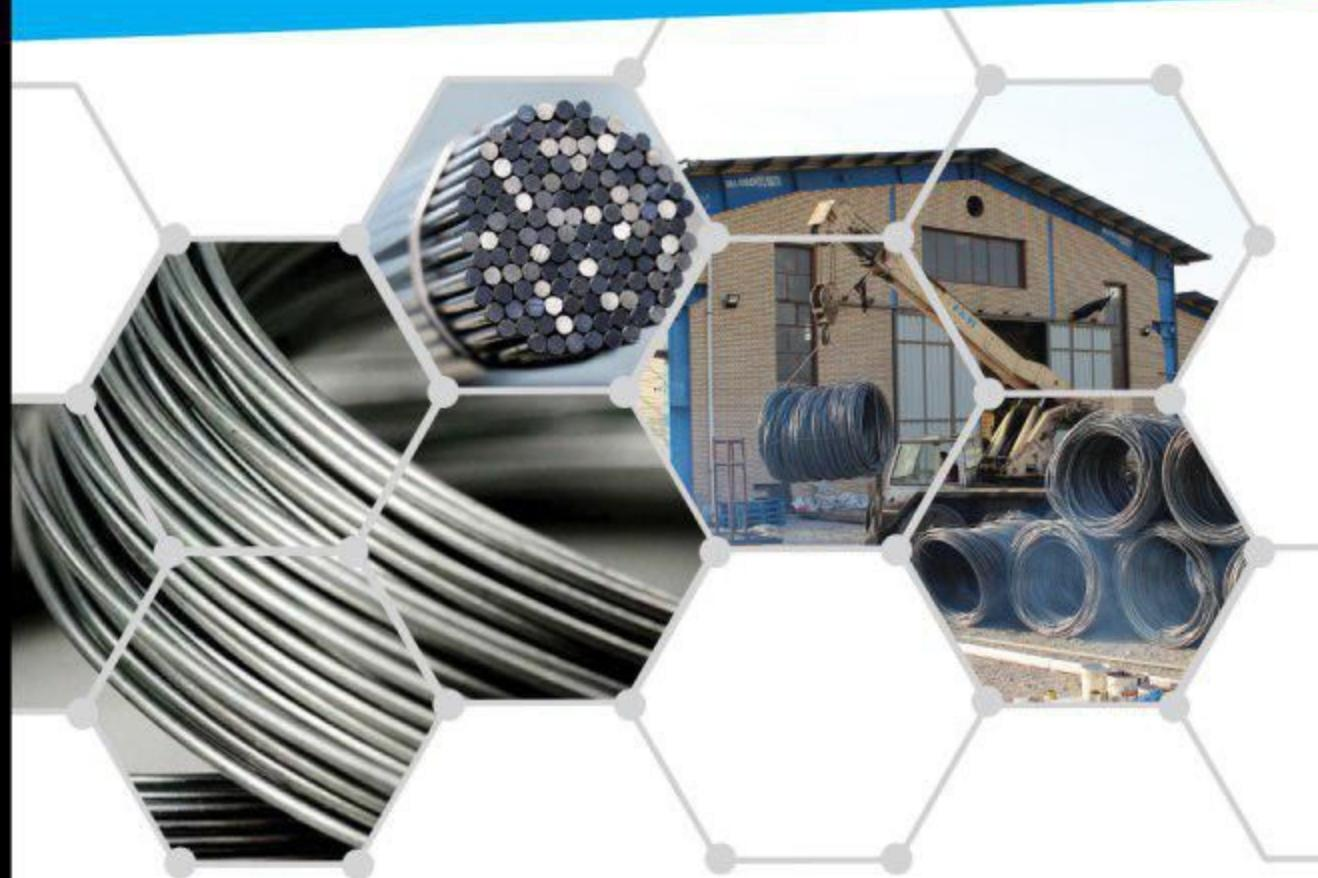
کلیه مواد اولیه به صورت کلاف و با گرید D 416 از شرکت فولاد آبیازی خریداری شده و طبق سفارش مشتری در سایزهای مختلف کشش می خورد و عملیات لازم جهت ساخت پیچ بر روی متریال انجام می پذیرد
